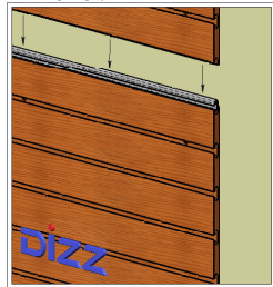
4. Monteer bovenliggend paneel in overgangsprofiel
